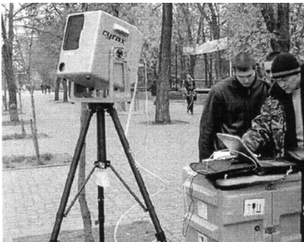
Рисунок 3.5 – Лазерный сканер Leica HDS2500
