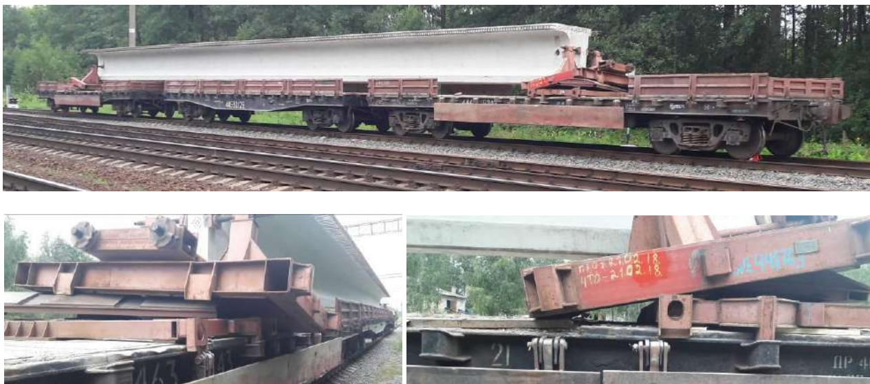
Рисунок 1– Последствия нарушений при эксплуатации турникетов грузоотправителем
