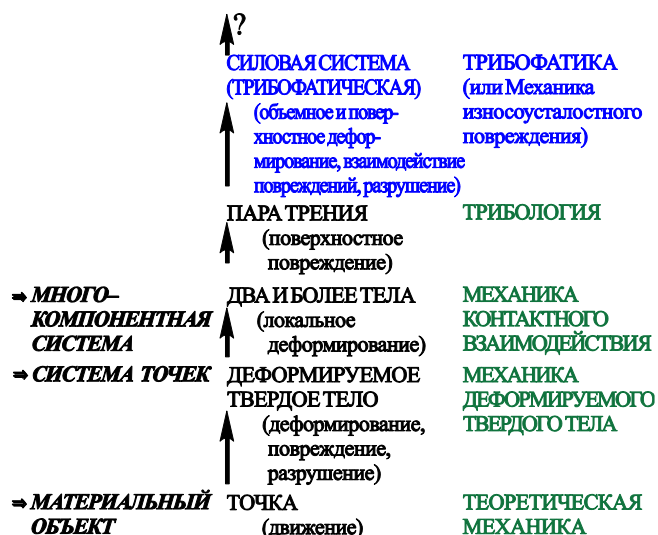
Рисунок 1 – Упрощенная иерархическая структура некоторых объектов, изучаемых в механике: от простого к сложному
