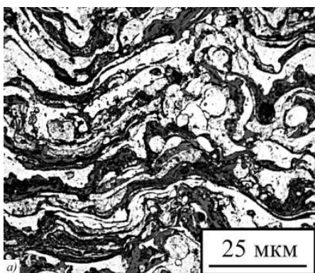
Рисунок 1 – Микроструктура газотермического покрытия из стали 40Х13
