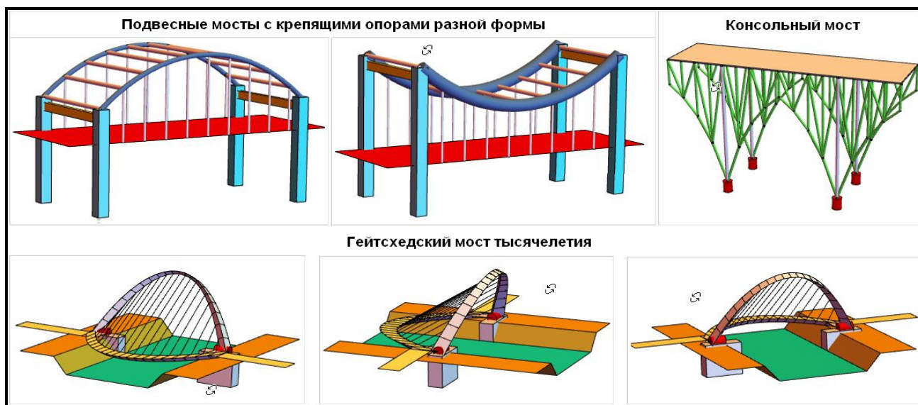
Рисунок 2 – Три модели разных конструкций мостов. Изображение Гейтсхедского моста дано в 3 ракурсах просмотра
