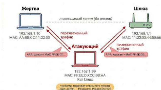
Рисунок 2 – Схема атаки ARP-спуфинг: перехват трафика между жертвой и шлюзом
