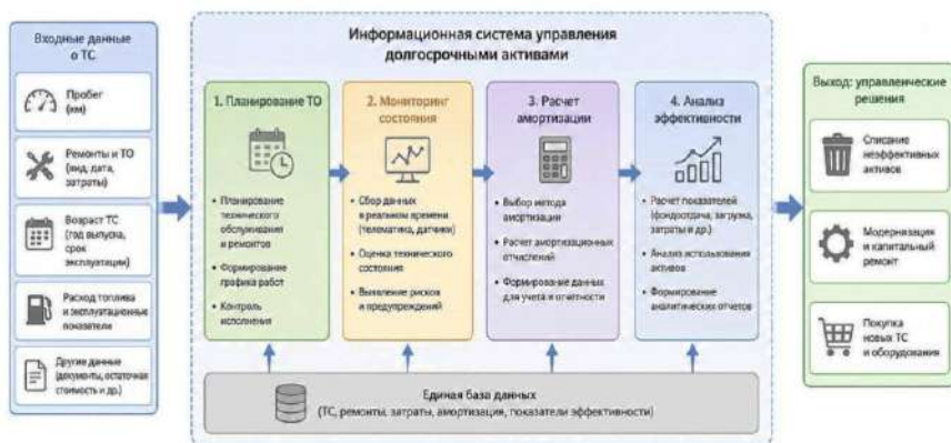
Рисунок 2 – Схема информационной системы управления долгосрочными активами транспортной организации
