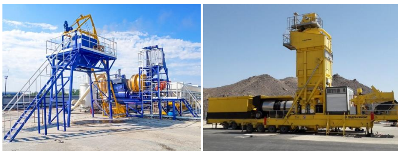
Рисунок 1 – Мобильный маломощный асфальтобетонный завод МАЗ-20 (слева) и высокопроизводительный асфальтобетонный завод Marini (справа)
