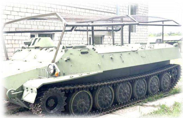
Рисунок 6 – МТЛБ, оборудованный противодронным козырьком
