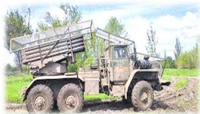
Рисунок 3 – БМ-21 «Град» на базе автомобиля Урал-375, оборудованный противодронным козырьком
