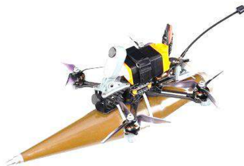
Рисунок 2 – Самодельный БПЛА с кумулятивной гранатой от РПГ-7
