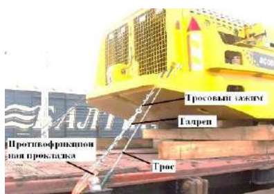
Рисунок 3 – Размещение и крепление колесной техники тросовыми растяжками
