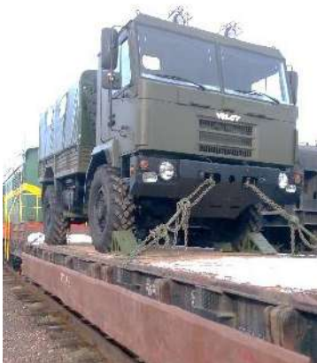
Рисунок 1 – Крепление колесной техники на базе МЗКТ-500200 при помощи УМК ЛК-00.000РЭ
