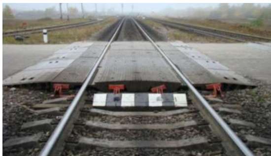
Рисунок 2.10 – Приспособление для определения нижней негабаритности подвижного состава
