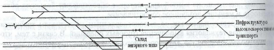
Рисунок 2 – Схема промежуточной станции для высокоскоростной линии крупным городом
