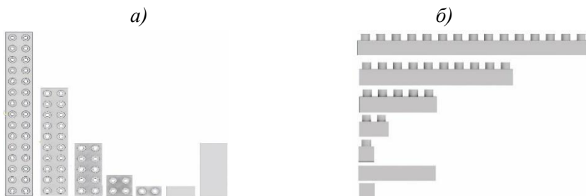
Рисунок 3 – Блоки для строительства временных быстровозводимых сооружений: а – вид сверху; б – вид сбоку
