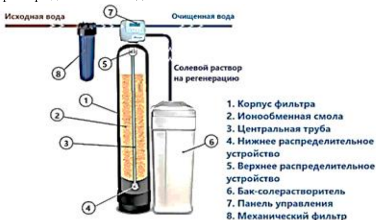
Рисунок 9 – Конструкция бытового ионообменного фильтра для очистки воды
