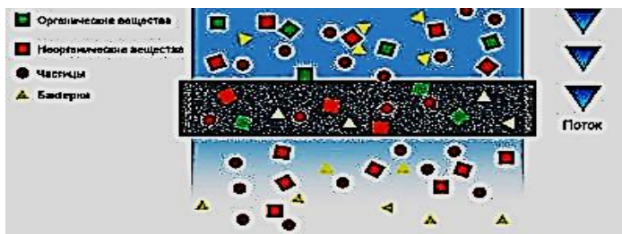
Рисунок 4 – Схема очистки воды сорбентами [10]
