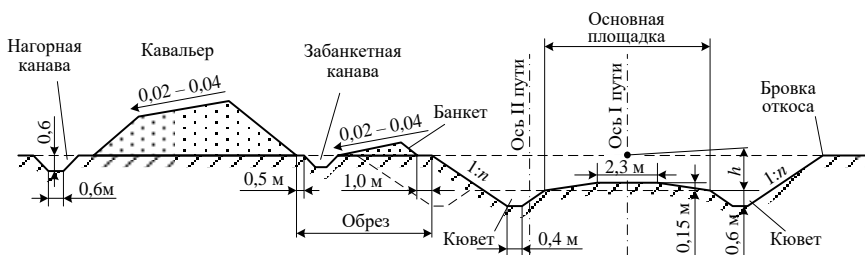
Рисунок 2.2 – Поперечный профиль выемки
