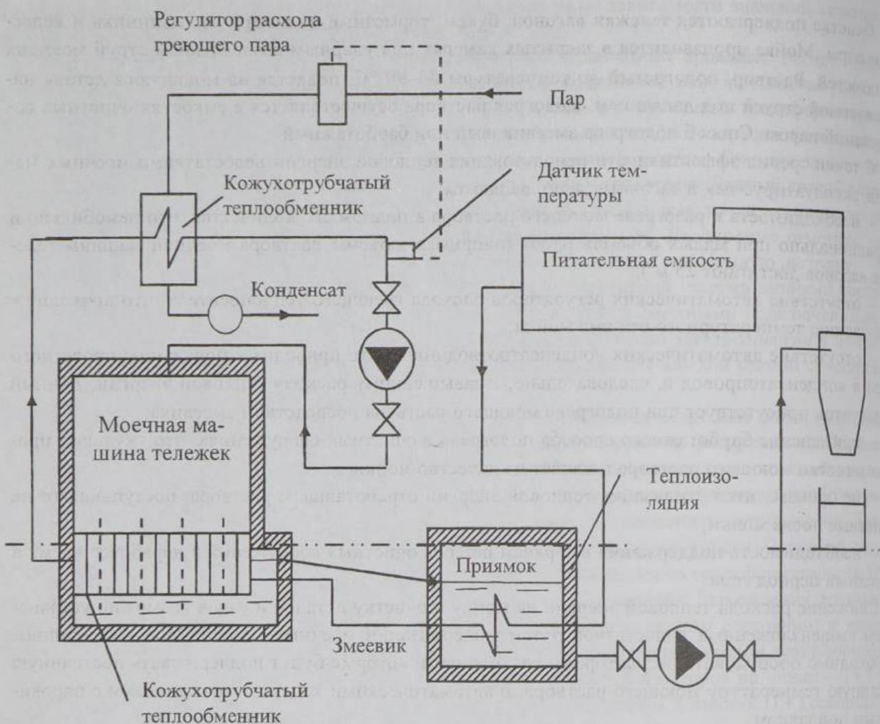
Рисунок 1 – Схема модернизированной моечной машины тележек
