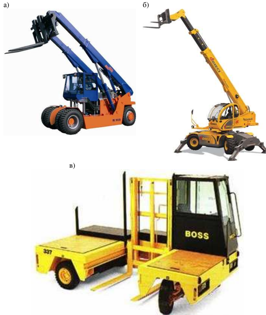
Рисунок 2.13 – Погрузчики: а – с фронтальной загрузкой; б – поворотнo-стреловой; в – с боковой загрузкой
