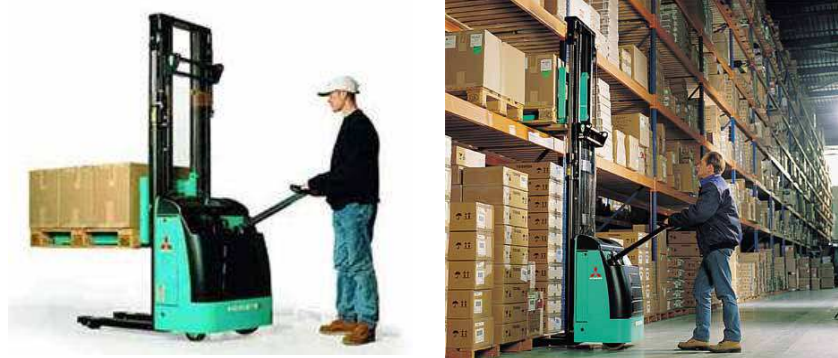
Рисунок 1.27 – Штабелер самоходный с электроподъемом
