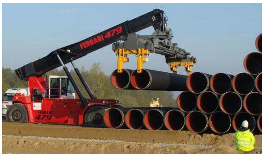
Рисунок 2.19 – Перегрузка труб автоматическим захватом
