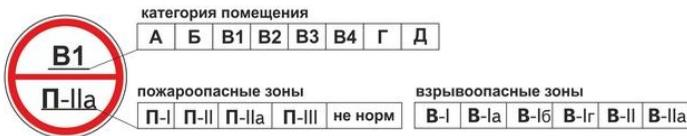
Рисунок 2 – Форма указателя категории помещения по взрывопожарной и пожарной опасности по ТКП 474–2013 и класса зоны по ПУЭ
