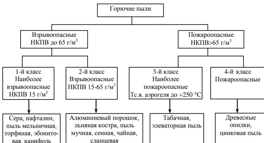
Рисунок 1 – Классификация пылей по степени пожарной опасности
