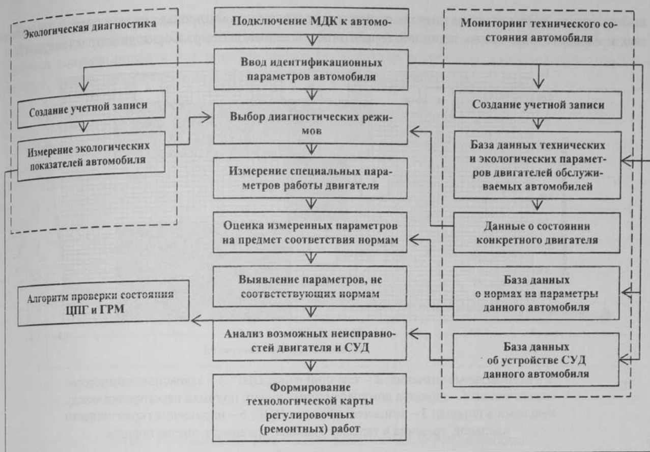
Рисунок 1 – Алгоритм работы МДК по оценке технического состояния СУД
