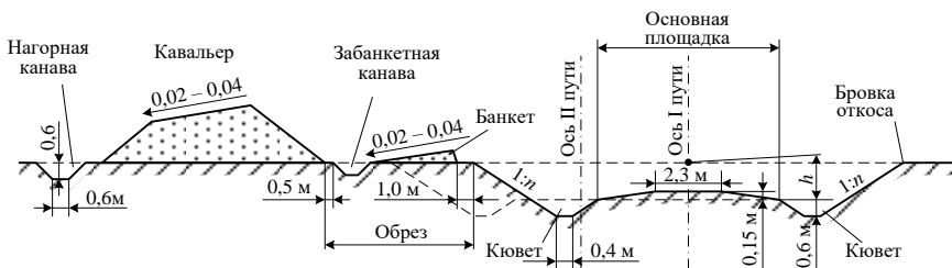
Рисунок 1.2 – Поперечный профиль выемки
