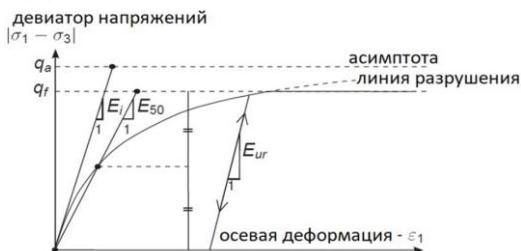
Рисунок 7 – Диаграмма Hardening Soil Model (модель упрочняющегося грунта)
