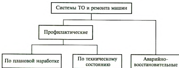
Рисунок 3.1 – Различные схемы технического обслуживания и ремонта машин
