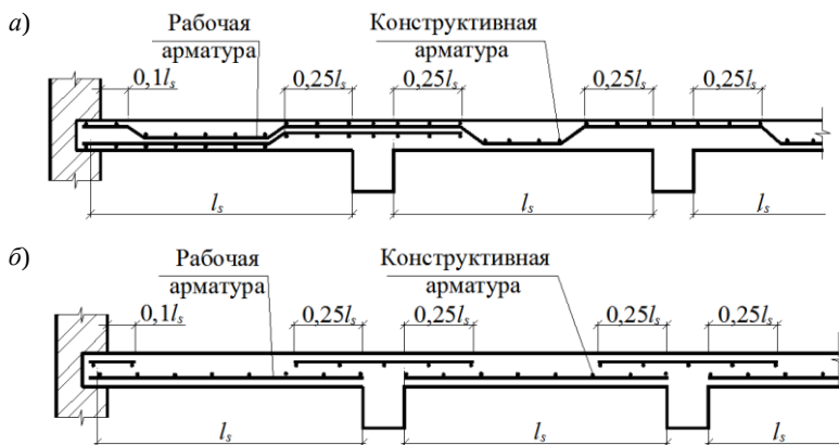
Рисунок 6.3 – Схема армирования плиты: а – рулонными сетками; б – плоскими сетками
