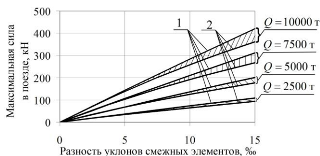
Рисунок 7 – Зависимости максимальных сил в поезде от величины перелома профиля и массы состава при R : 1 – 5 км; 2 – 20 км
