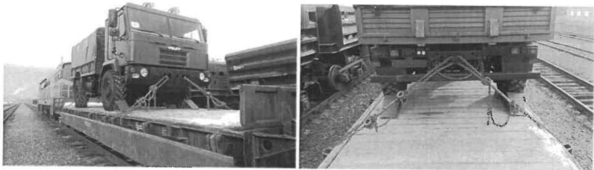
Рисунок 2 – Крепление колесной техники на базе МЗКТ-500200 при помощи УМК ЛК-00.000РЭ
