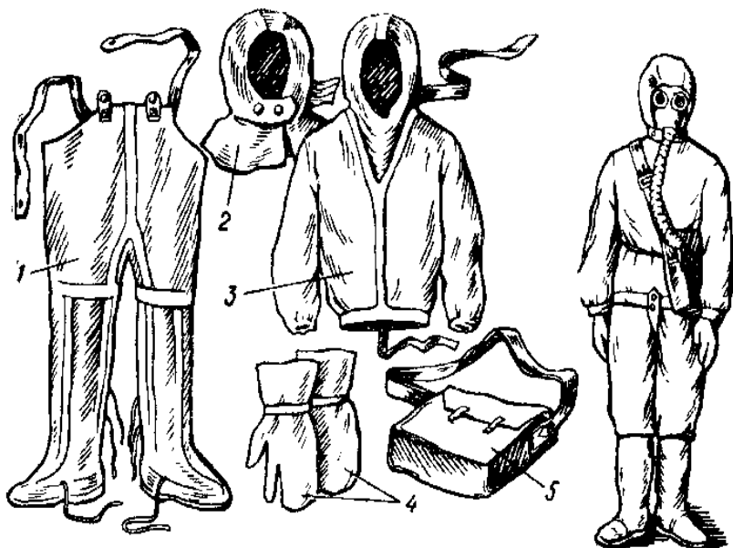
Рисунок 10.7 – Легкий защитный костюм Л-1: 1 – брюки с чулками; 2 – подшлемник; 3 – рубашка с капюшоном; 4 – двупалые перчатки; 5 – сумка для хранения. Справа – защитный костюм в «боевом» положении
