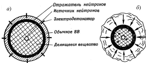
Рисунок 6.3 – Ядерный заряд деления «имплозивного» типа:
