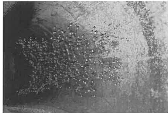
Рисунок 1 – Кавитационная эрозия: а – крыльчатки насоса; б – трубопровода
