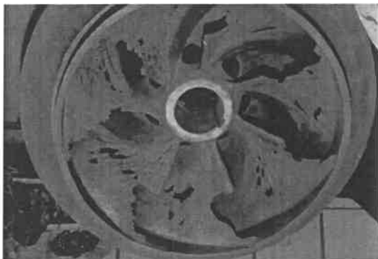
Рисунок 1 – Кавитационная эрозия: а – крыльчатки насоса; б – трубопровода
