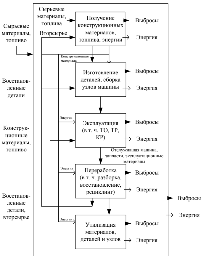
Рисунок 3.6 – Схема жизненного цикла машины с потоками материалов и энергии (выбросы – это любое загрязнение окружающей среды)
