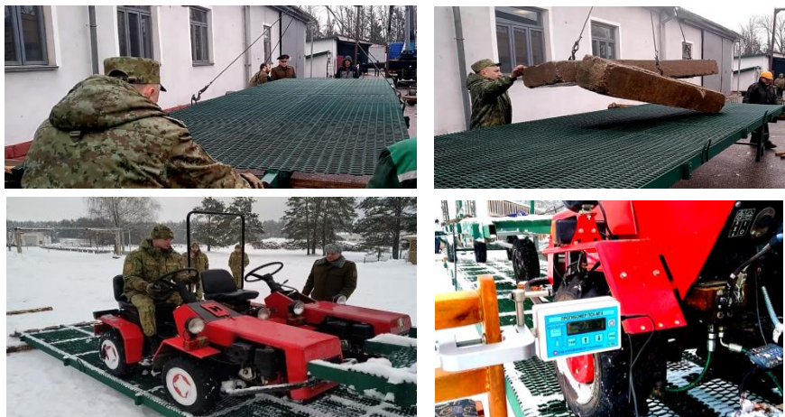
Рисунок 2 – Натурные испытания малогабаритных мостов в полевых условиях
