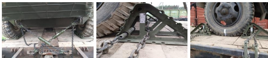
Рисунок 5 – Крепление техники при помощи МККТ Л1
