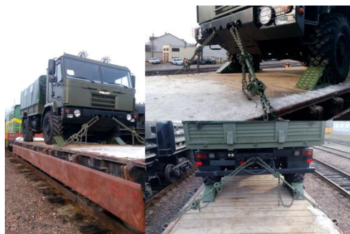
Рисунок 4 – Крепление колесной техники на базе МЗКТ-500200 при помощи УМК ЛК-00.000РЭ
