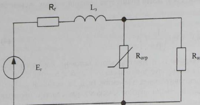
Рисунок 2 – Включение индуктивности в продольную ветвь схемы защиты
