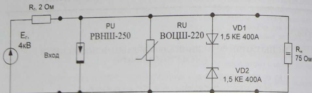
Рисунок 2 – Параллельное подключение быстродействующих защитных элементов
