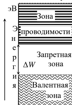
Рисунок 1.1 – Запретная зона на энергетической диаграмме полупроводников и диэлектриков
