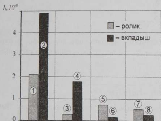
Рисунок 1 – Интенсивность изнашивания наплавочных материалов: 1, 2 – ПП-АН 180 МН; 3, 4 – ОЗН-300М; 5 – LASTEK 807; 6 – Булат-1; 7 – Wearshield/Mangiet; 8 – ПП-АН 180 МН
