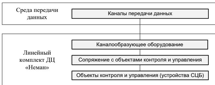
Рисунок 3.2. – Структурная схема линейного комплекта ДЦ «Неман» без сервера
