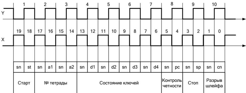
Рисунок 4.11 – Временная диаграмма цикла обмена данными блока ТУ16
