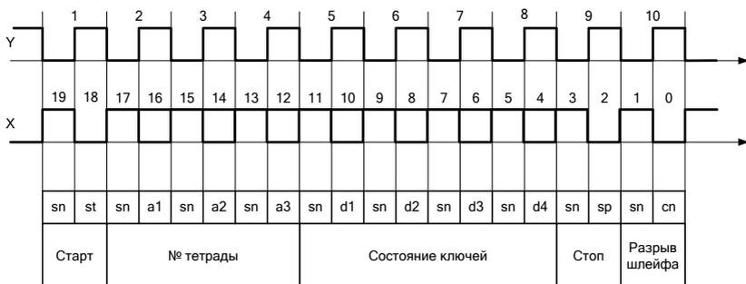
Рисунок 4.12 – Временная диаграмма цикла обмена данными блока ТС32
