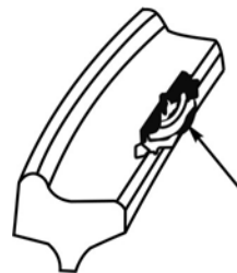
Рисунок 3.7 – Поверхностный откол наружной грани обода колеса
