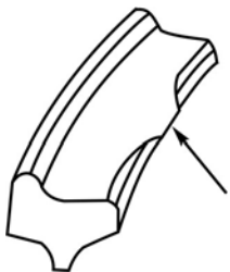
Рисунок 3.6 – Местное уширение обода колеса (раздавливание)
