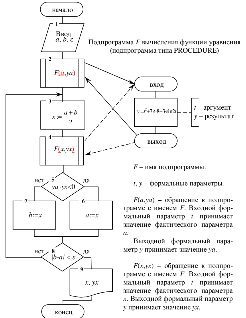
Рисунок 2.4 – Блок-схема алгоритма уточнения корней методом половинного деления
