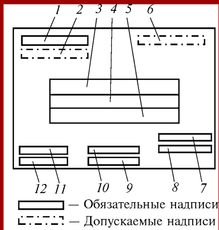
Рис. 12.2. Порядок расположения транспортной маркировки: 1 — манипуляционные знаки; 2 — допускаемые предупредительные надписи; 3 — порядковый номер внутри отправки, число мест в отровке; 4 — наименование грузополучателя и пункта назначения; 5 — наименование станции перегрузки; 6 — железнодорожная маркировка; 7 — наименование грузоотправителя; 8 — наименование станции отправления; 9 — масса нетто; 10 — масса брутто; 11 — габаритные размеры грузового места
