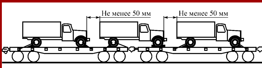
Рис. 33.3. Схема размещения и крепления машин на колесном ходу на сцепе из двух платформ
