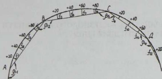
Рисунок 2 – Схема съемки кривой способом И. В. Гоникберга
