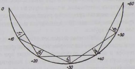
Рисунок 1 – Схема съемки кривой
