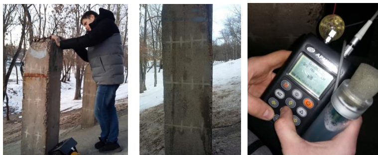
Рисунок 1 – Процесс измерения прибором АРМКОР-1
