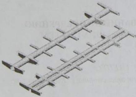
Модели рам полувагонов с хребтовыми балками с одной круглой трубой и двумя
