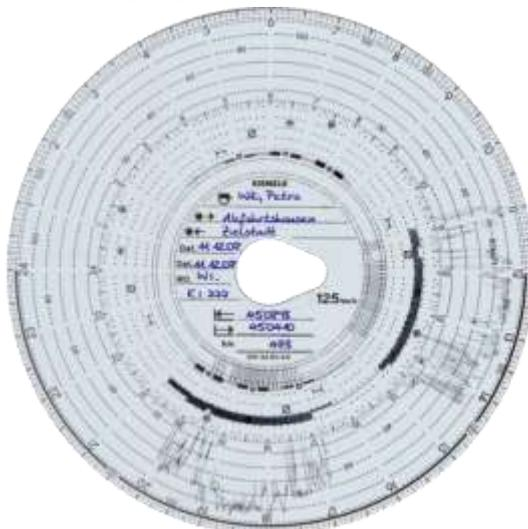
Рисунок 5.3 – Заполненный диаграммный диск тахографа
