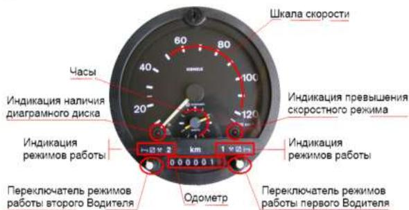
Рисунок 5.1 – Передняя панель аналогового тахографа
