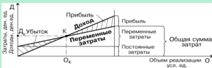
Рис. 2.4. К расчету точки безубыточности:
