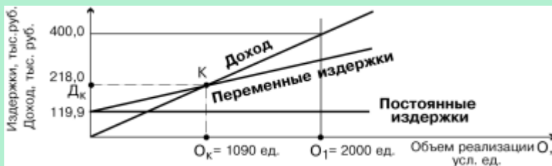
Рис. 3.5. Пример расчета точки безубыточности:
