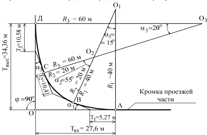
Рисунок 9.5 – Разбивка сопряжения кромки проезжей части
