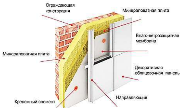
Рисунок 1 – Схема системы наружной теплоизоляции «вентилируемых» фасадов
