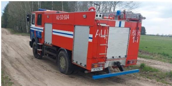
Рисунок 2 – Движение пожарной автоцистерны на шасси МАЗ-5337 с резервуаром объемом 5 \text{ м}^3 в соответствии с режимом № 2
