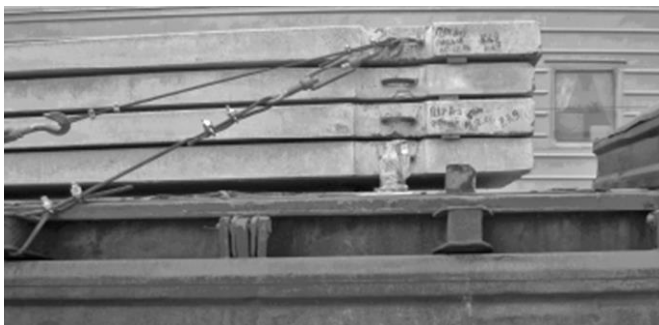
Рисунок 2 – Многоярусная погрузка железобетонных плит
