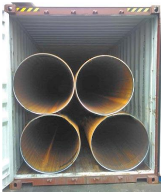
Рисунок 5 – Размещение труб в универсальном контейнере
